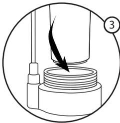
3 Coloque la nueva unidad filtrante encastrándola en el centro de la base del dispositivo. No presione al insertarla.
